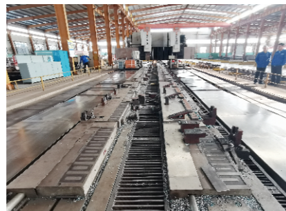
Linear guide milling
